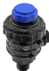
Filtro de sucção com válvula, saídas de rosca 1 1/4" capacidade de 80 l/min. elemento filtrante malha 50
